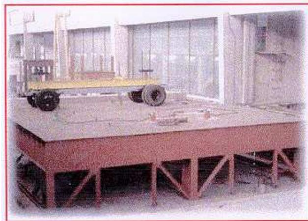
Figura 7.2: Modelo Experimental do Vão Central da Ponte Rio-Niterói (Escala 1:1)
