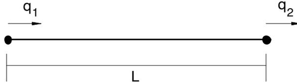
Figura 3.2: Elemento de MVE Unidimensional
