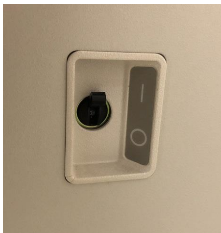
Figura 6 - Chave Liga/desliga da ultracentrífuga.
