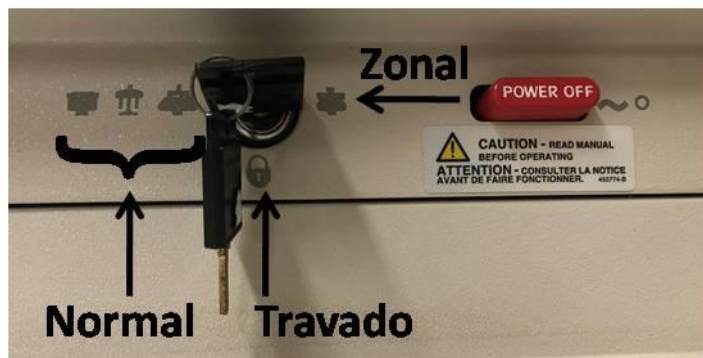
Figura 8 - Chave seletora posicionada na posição Normal.
