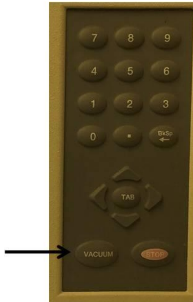
Figura 10 Posição do botão de controle da bomba de vácuo.
