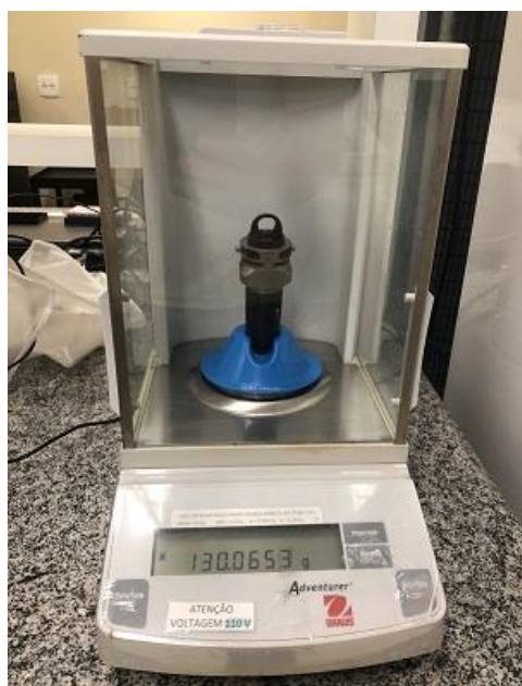
Figura 3 - Pesagem de tubo na balança Ohaus Adventurer.
