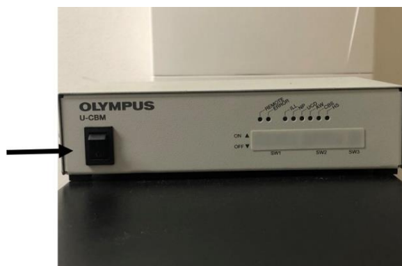
Figura 2 – Indicação da chave liga/desliga no módulo de controle dos filtros de fluorescência.
