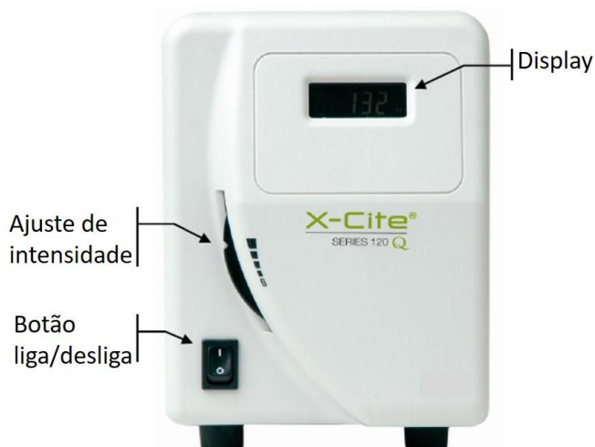
Figura 3 – Vista frontal do módulo da lâmpada de mercúrio (adaptada do manual X-Cite 120Q User Guide).
