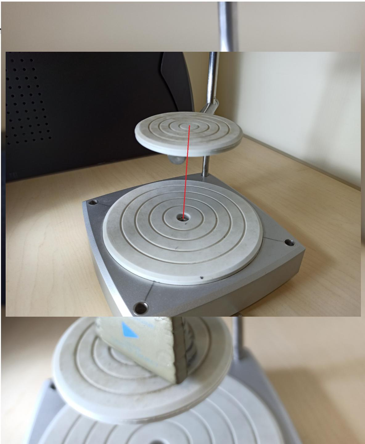
**Ajuste a altura da plataforma superior e a posição lateral da mesa de forma que todo o objeto esteja visível na câmera do scanner (verifique a imagem que aparece no computador)**
