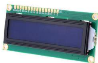
Figura 49 – Display LCD 16x2
