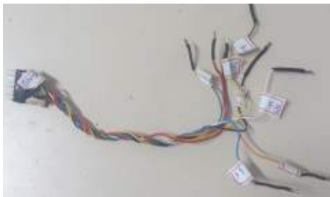
Figura 20: Foto do cabo que conecta as entradas do Header e os pinos do microcontrolador
