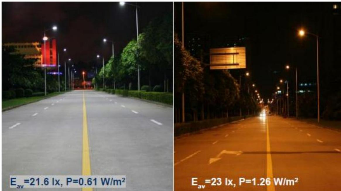
Figura 7. Foto de uma via iluminada com LED (à esquerda) e VSAP (à direita). (TECNOWATT/SIMON LIGHTING)
