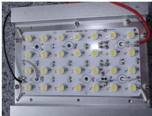
Figura 21. Arranjo de LEDs utilizado para os experimentos
