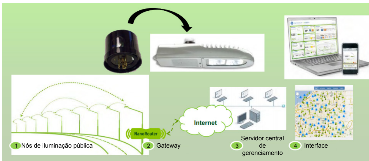
Figura 12. Sistema de telegestão da GE lighting. (ROSITO, 2013)
