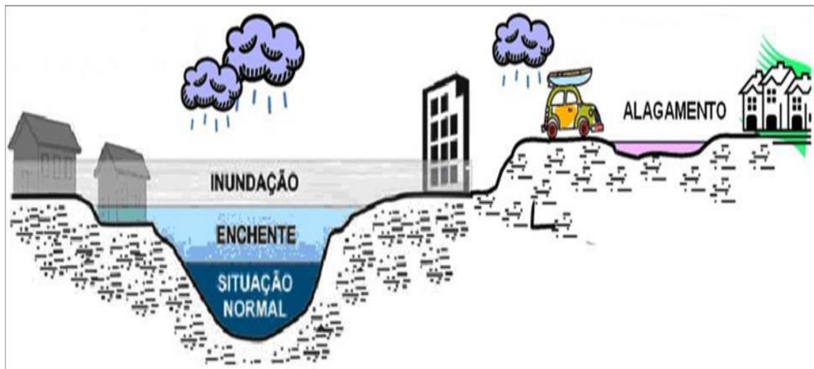
Figura 7 - Processos de enchente, inundação e alagamento
