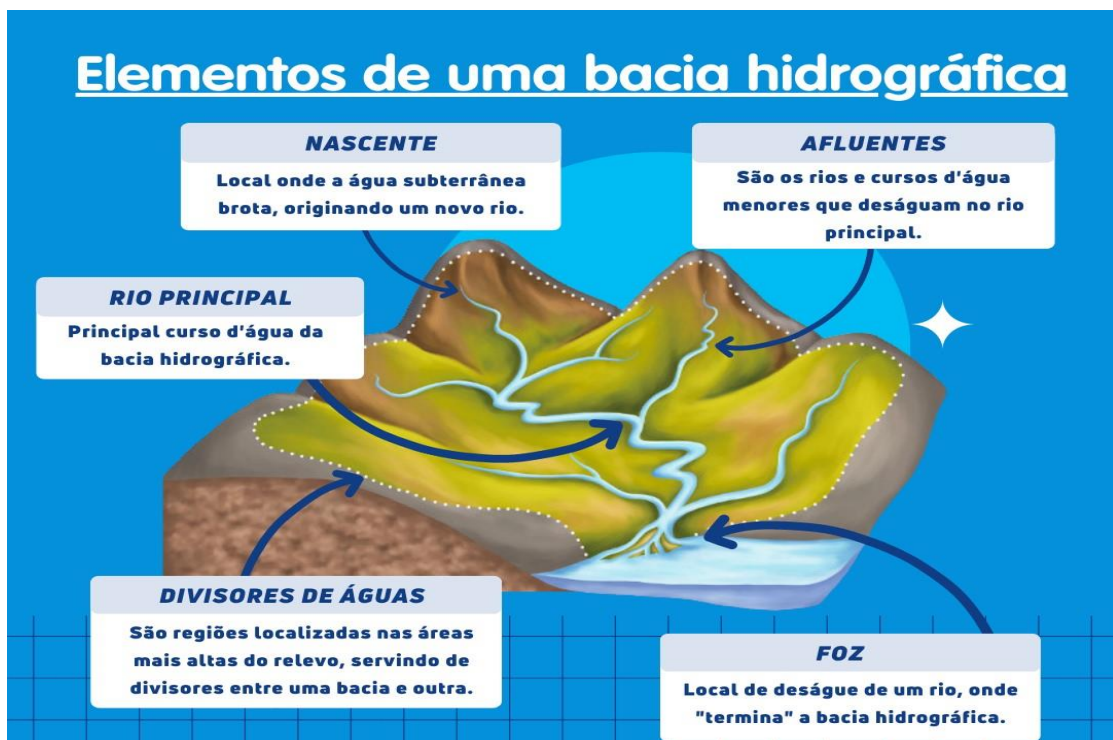
Figura 2 - Esquema representativo de uma bacia hidrográfica
