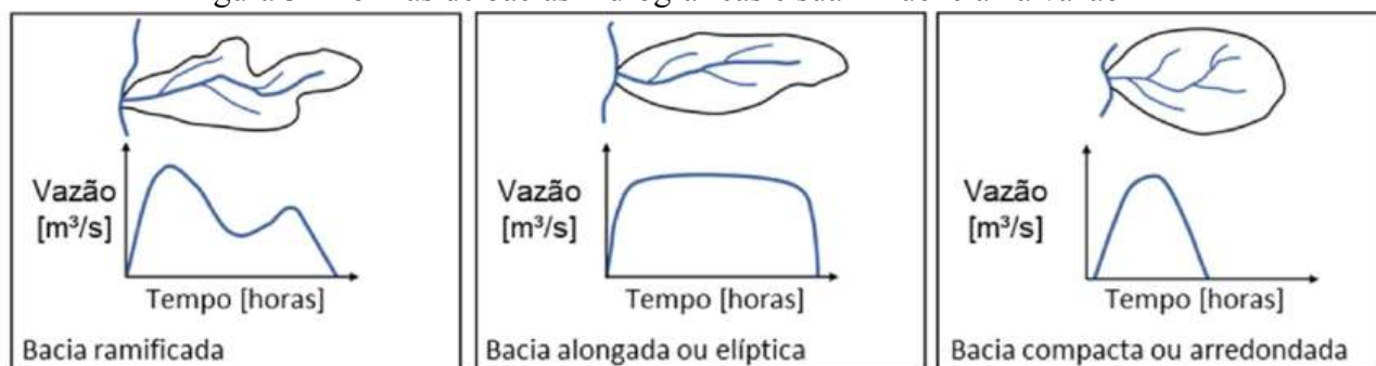
Figura 3 - Formas de bacias hidrográficas e sua influência na vazão
