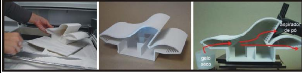
Prototipagem rápida - modelo executado na impressora 3D Fonte: Pupo (2009, p.32)
