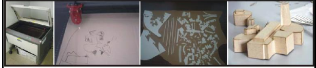
Modelo executado em cortadora a laser Fonte: Pupo (2009, p.39)
