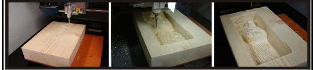
Modelo executado em fresadora com um eixo Fonte: Pupo (2009, p.40)
