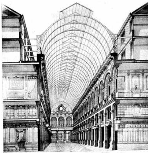
Perspectiva con cubierta. —Dibujo de la perspectiva de una galería del Pasaje con sujeción a una de las soluciones planteadas durante el desarrollo del estudio del Proyecto, con cubierta de hierro y cristal.
