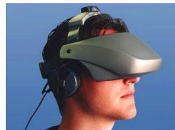
Fig. 8 | *HMD (Head Mounted Display)* - capacete de imersão em ambientes de realidade virtual.
