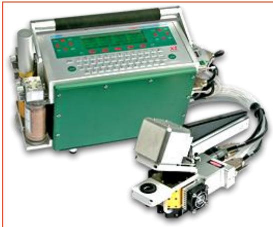
**Analizador de Gases no Infra-vermelho**
