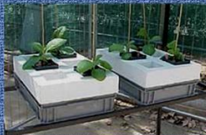
Sistema para exposição do tabaco para análise e detecção de ozônio
