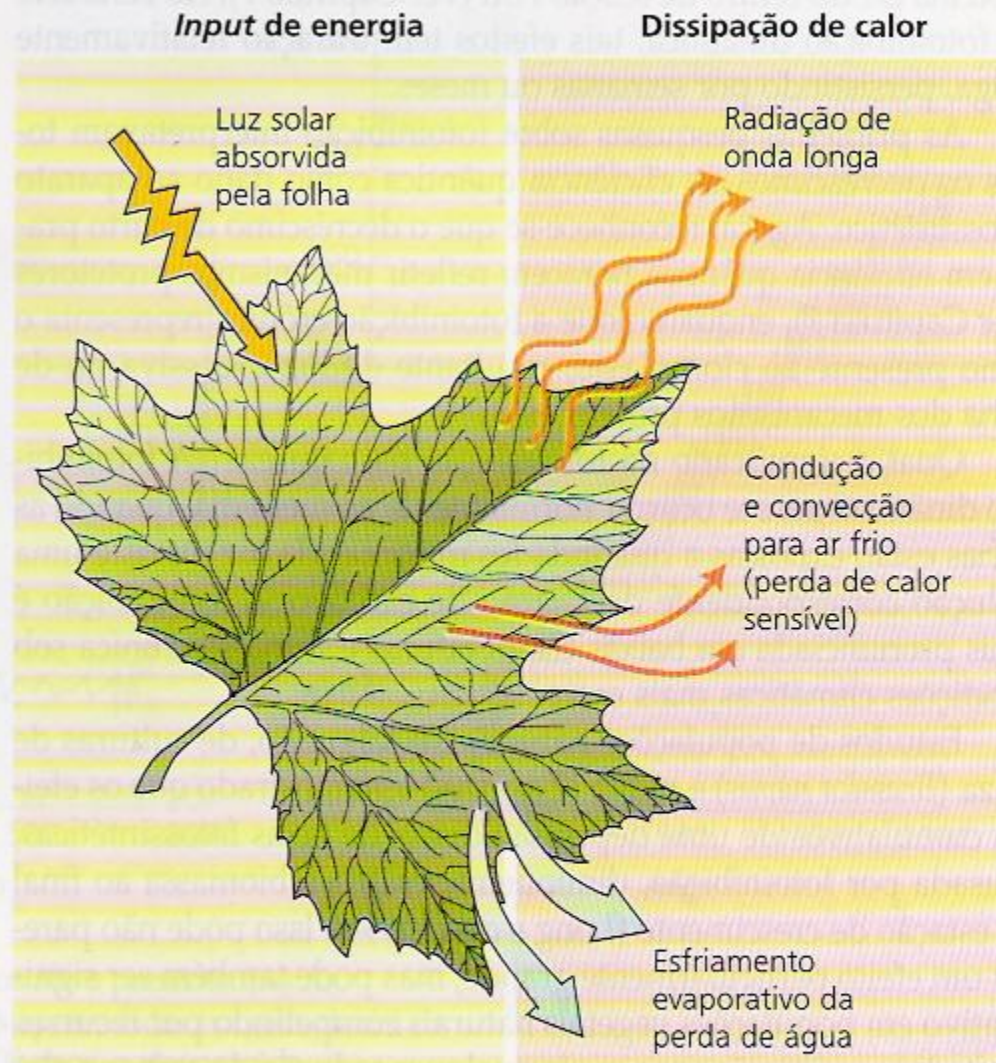
FIGURA 9.14 Absorção e dissipação de energia da luz solar pela folha. A carga de calor imposta deve ser dissipada, a fim de evitar dano à folha. A carga de calor é dissipada pela emissão de radiação de ondas longas, pela perda de calor sensível para o ar que circunda a folha e pelo esfriamento evaporativo causado pela transpiração.
