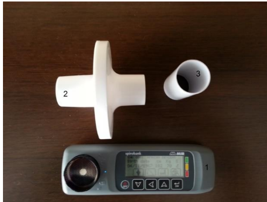
Figura 1: 1) Espirômetro portátil modelo MIR Spirobank USB®, 2) Filtro, 3) Bocal descartável. Fonte: Os autores
