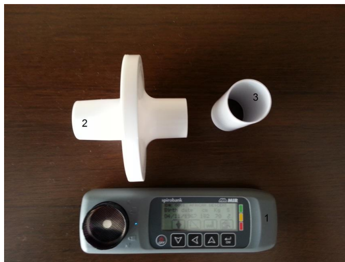
Figura 1: 1) Espirômetro portátil modelo MIR Spirobank USB ® , 2) Filtro. 3) bocal descartável.
