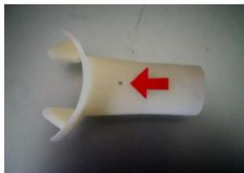
Figura 3: Bocal de borracha semi-rígida, tipo mergulhador, utilizado nas avaliações. A seta vermelha indica o orifício de escape aéreo com 2 mm de diâmetro.
