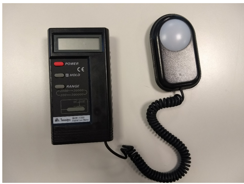
Figura 21. Imagem do luxímetro Minipa usado nas medições de iluminância apresentado na Figura 21.
