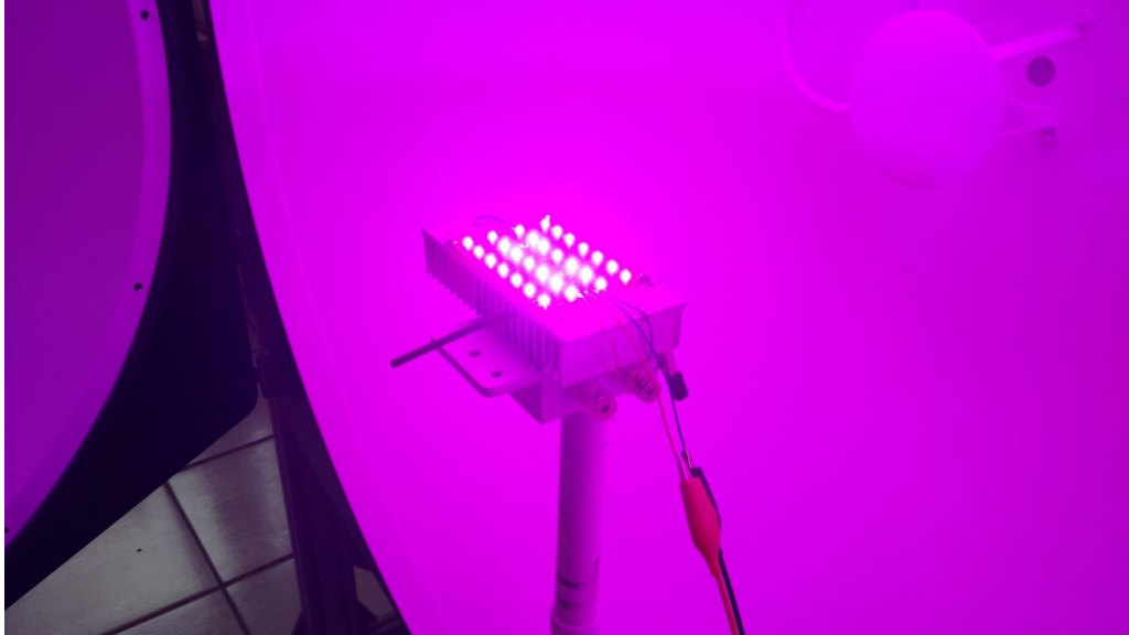
Figura 46: Ensaio da luminária nova dentro da esfera integradora.
