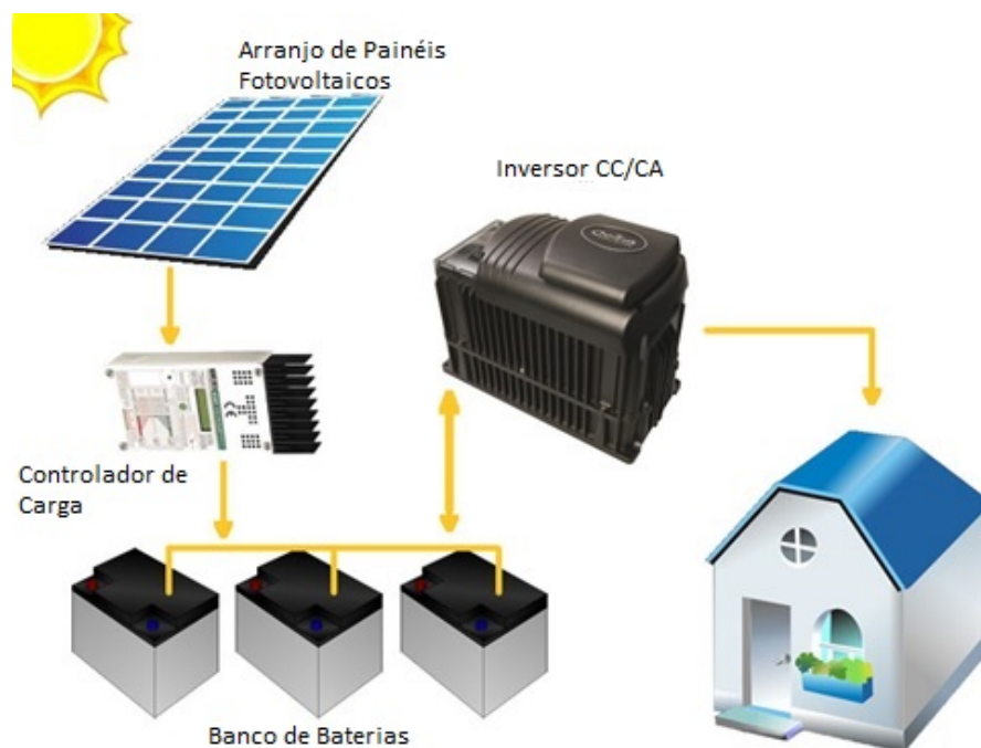
Figura 9 – Esquema simplificado de um sistema solar fotovoltaico off-grid
