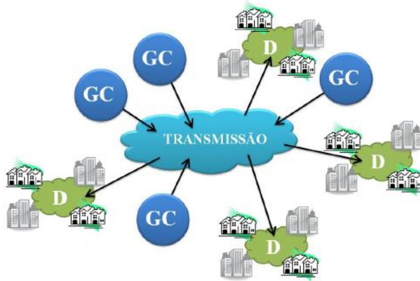
Figura 4 – Esquema simplificado de um sistema elétrico interligado com geração centralizada
