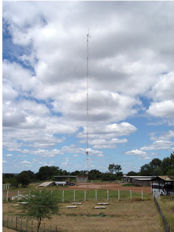
Figura 1 – Torre com anemômetros a 10m, 25m e 50m de altura. Petrolina. Fonte: INPE.
