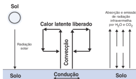
Figura 6 – Aquecimento do ar
