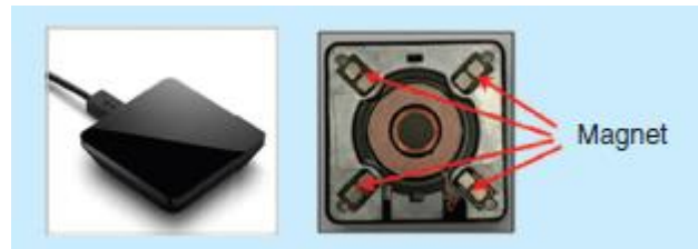
Figura 14 – Exemplo de produto para carregamento de dispositivos utilizando transmissor de 1 bobina e ímãs para auxílio de posicionamento.
