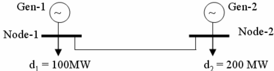
Figura 8: Sistema de dois barramentos
