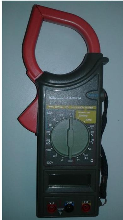
Figura 3.4 - Alicate amperímetro
