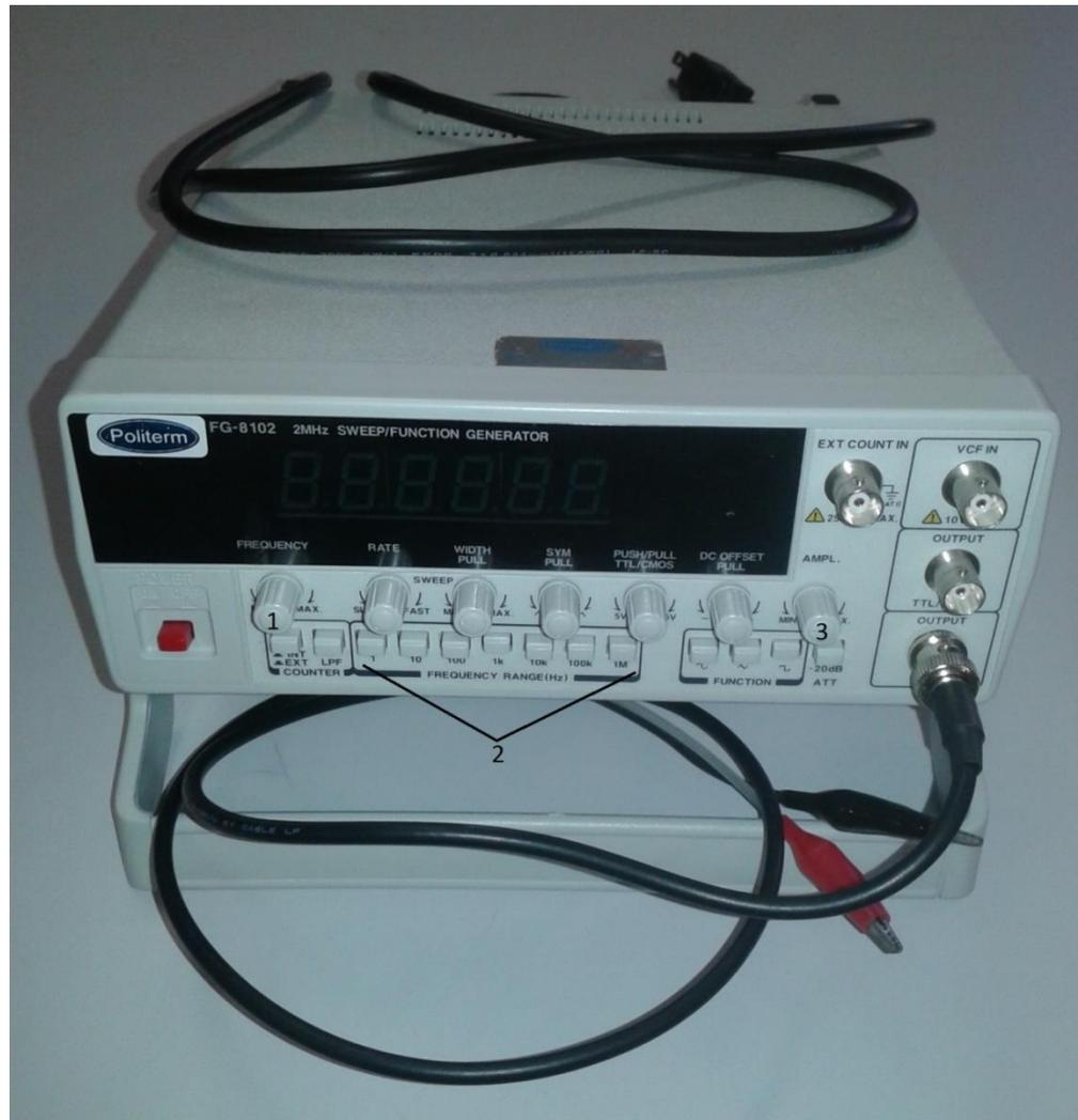
Figura 3.3 – Gerador de função
