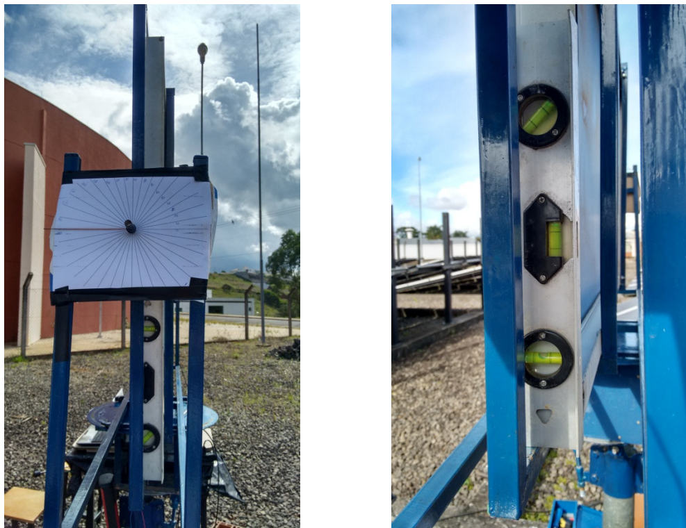
Figura 27: Método para calibração dos eixos em graus.
