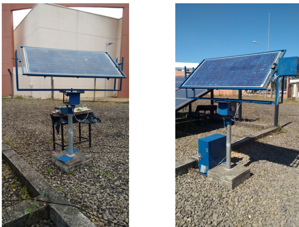
Figura 14: Estrutura mecânica para posicionamento automático de um painel solar fotovoltaico.
