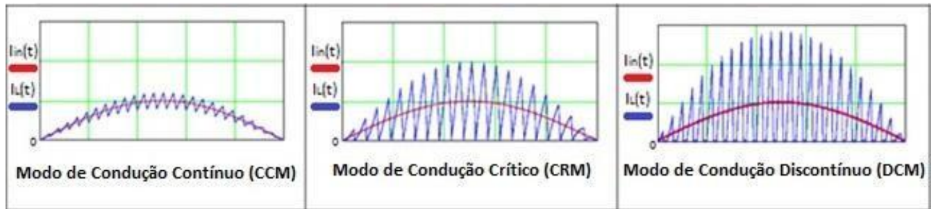
Figura 5. Modos de operação CCM, CRM e DCM
