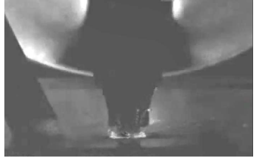
Figura 42 - Pino é inserido na poça de solda
