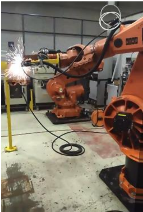
Figura 71 - Soldagem do segundo pino e dos subsequentes
