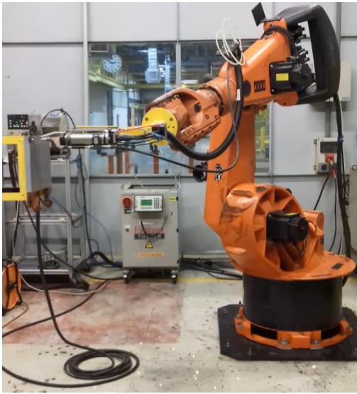
Figura 69 – Finalização da primeira solda e recuo da pistola
