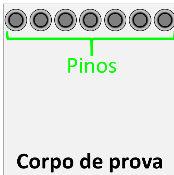
Figura 62 - Esquemático do resultado esperado: pinos soldados sobre o corpo de prova
