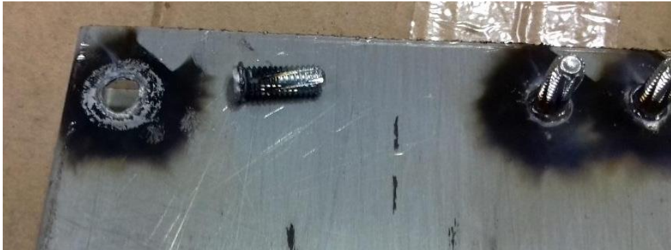
Figura 46 - Detalhe do pino removido, que retirou parte da chapa sem desfazer a solda
