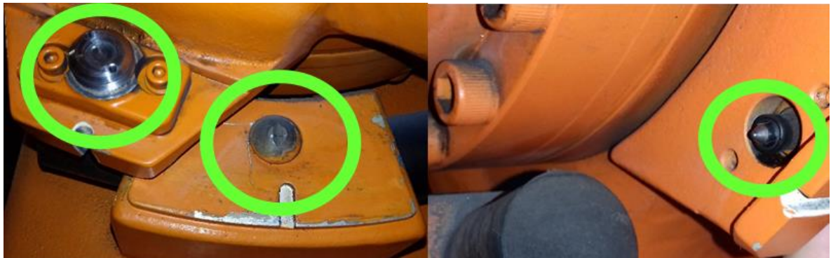
Figura 53 – Da direita para a esquerda: conexão eletrônica, entalhe de referência e pino de medição
