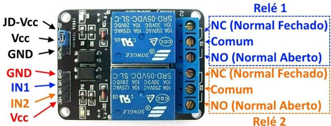
Figura 5 - Esquema da pinagem do relé SRD-05VDC-SL-C [2]
