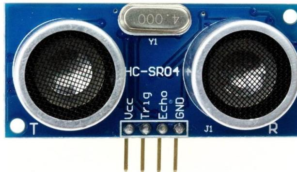
Figura 6 - Sensor ultrassônico HC-SR04. [11]
