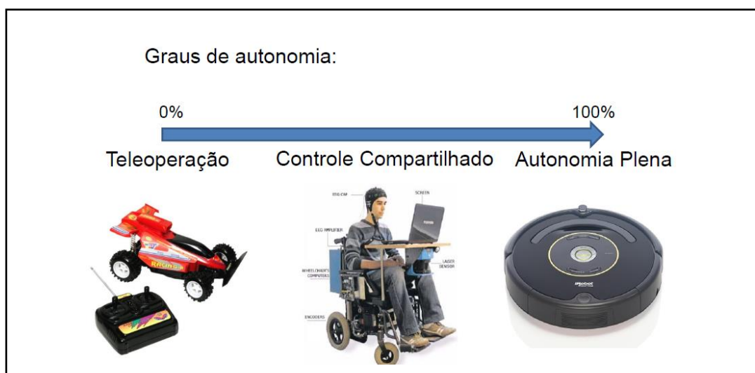
Figura 6 – Diferentes graus de autonomia em robótica móvel (CARDOZO, 2014).
