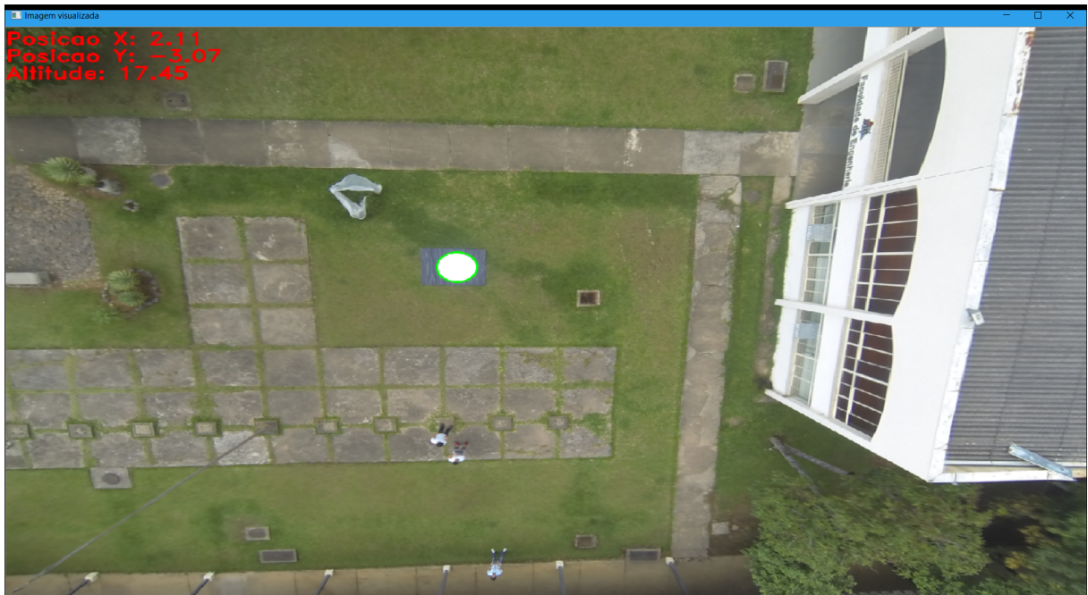
Figura 59 – Detecção de altitude e posições a voar com o quadrotor a também aproximadamente dezessete metros de altitude e com visada diferente do landmark .
