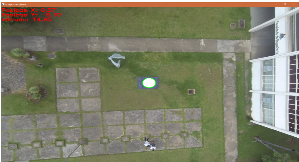
Figura 60 – Detecção de altitude e posições a voar com o quadrotor a aproximadamente quinze metros de altitude, já em um momento de pouso sobre o landmark .
