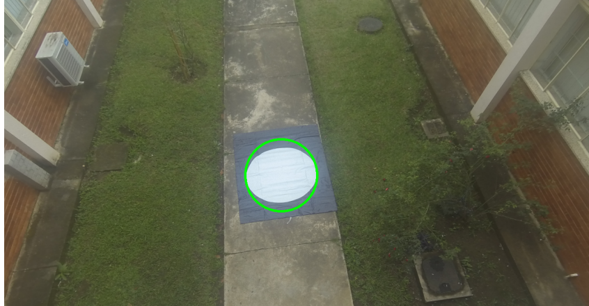
Figura 38 – Reconhecimento do landmark em dia nublado, em um plano inclinado em relação ao plano da câmera.
