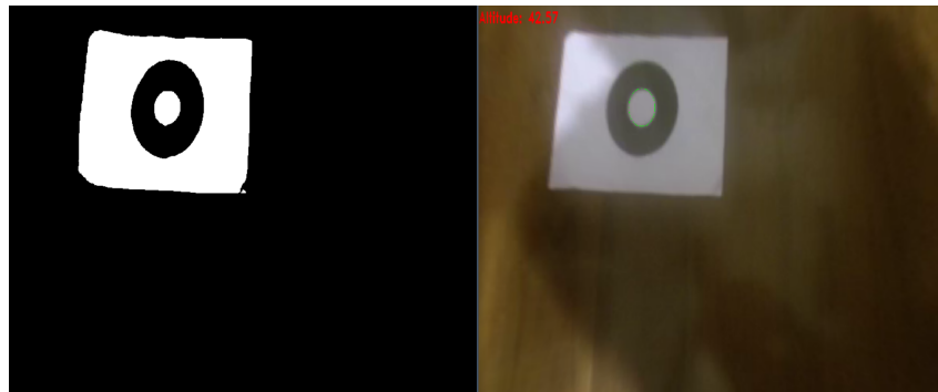
Figura 55 – Landmark reconhecido e valor de altitude em centímetros.
