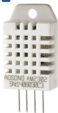
Figura 4 - Sensor termohigrometro AM2302/DHT22. Fonte: Thomsen, 2019
