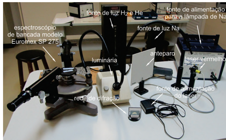
Fig. 6.10: Descrição de todos os componentes usados na experiência de espectro atômico.
