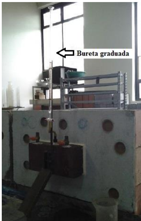
FIGURA 3.6: Execução do ensaio de permeabilidade à água
