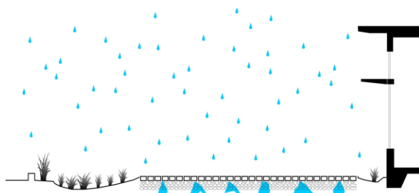
Figura 8 – Corte esquemático de pavimento poroso
