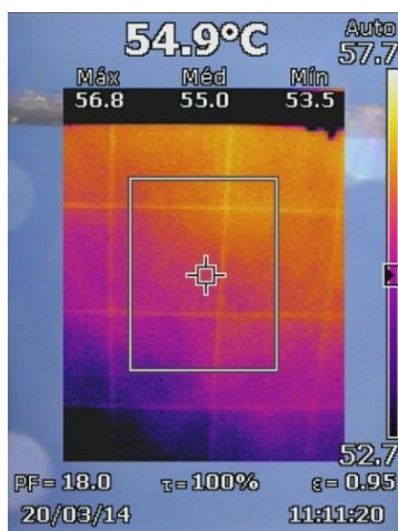
Figura 65 - Medida posterior - sem aletas (20/03/2014)
