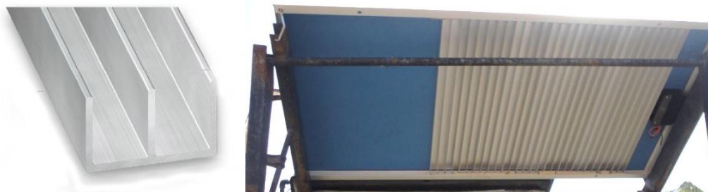
Figura 59 - Perfis em alumínio unidos para formação de dissipador
