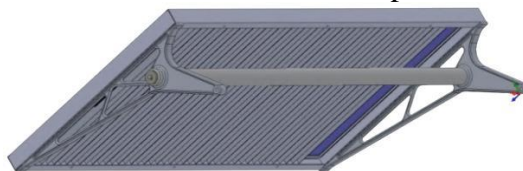
Figura 49 - Placa fotovoltaica montada em suporte e barra horizontal
