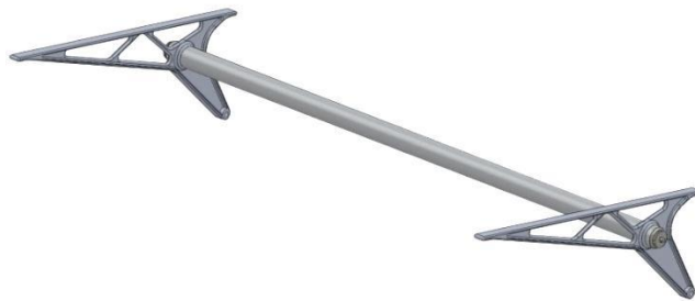
Figura 45 - Suportes laterais encaixados em barra cilíndrica horizontal
