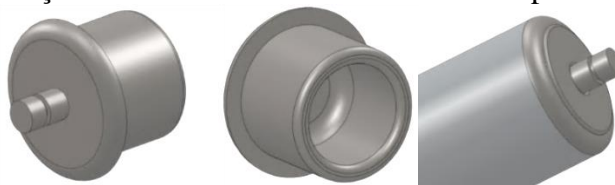
Figura 46 - Peça de encaixe entre barra cilíndrica e apoio vertical
