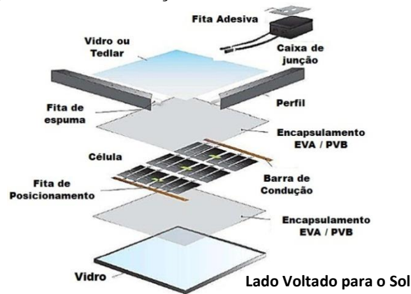
Figura 16 - Constituição do módulo fotovoltaico
