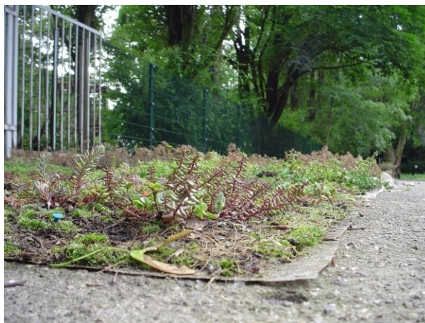
Figura 6: Experimento de mantas com espessuras mínimas (5 cm) no IASP/HU- Berlin. Fonte: Rola (2008).
