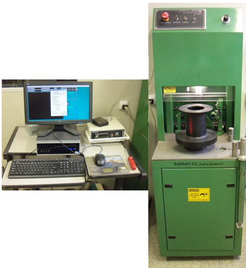
Figura 12– Compactador Giratório do Laboratório de Pavimentação da UFJF, composto por um sistema de aquisição de dados e o compactador de misturas (Fonte: o autor)
