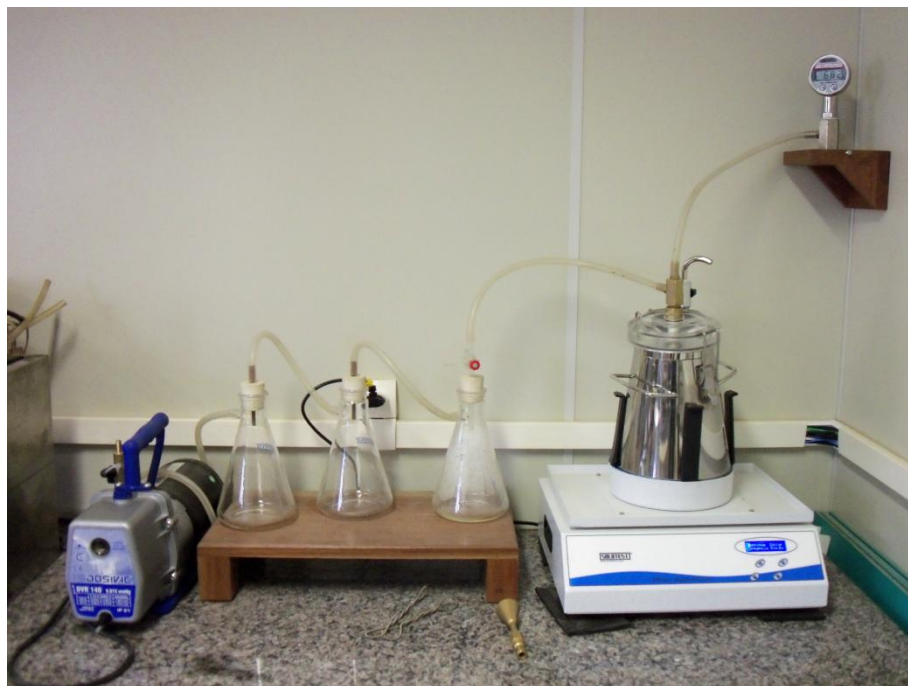
Figura 47– Equipamento utilizado para a determinação da DMM
