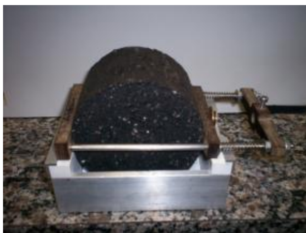
Figura 17– Montagem do suporte do LVDT (GENELHU, 2009)
