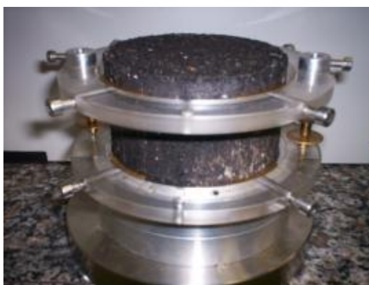
Figura 22– Montagem das alças dos LVDTs (GENELHU, 2009)
