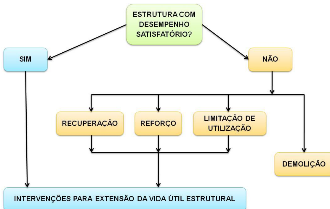
FIGURA 5 - Esquema hipotético para reconversão de estruturas de concreto com desempenho insatisfatório (RIPPER; SOUZA, 1998)
