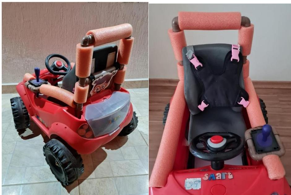
Figura 1: Imagem de um dos veículos motorizados adaptados pelo projeto Adapt.
